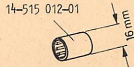
Bemerkung: Nadellager Nr. 14-515 009-01 kann durch Nadellager Nr. 14-515 012-01 nicht ersetzt werden (größerer Außendurchmesser).
